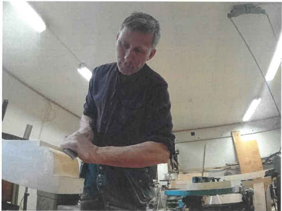
Torbjørn Dahl i ferd med å lage nye sperrer og omrammingsdetaljer til spissgavler og lydglugger.
